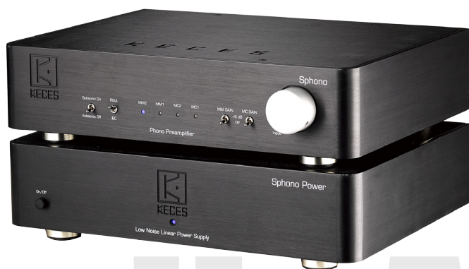
面板右邊的銀色旋鈕用來切換四個唱頭輸入，面板上四個小撥桿由左至右分別是Subsonic轉轉聲濾除開關、等化曲線切換、MM增益切換、MC增益切換。
